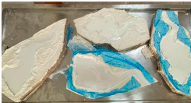
Figura 2. (C) Molde negativos de membros torácico e pélvico canino preenchidos com silicone líquido para fabricação do modelo simulador de punção venosa.
